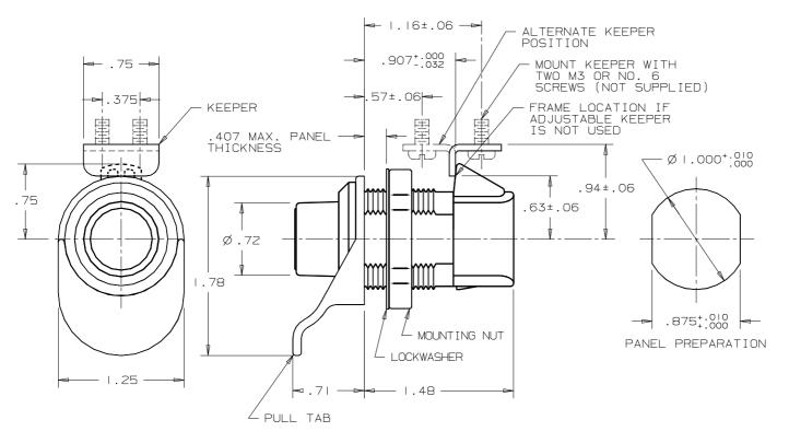
PULL TAB MAY BE INSTALLED 180° FROM POSITION SHOWN
